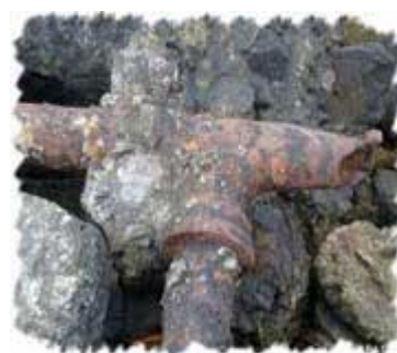
این لوله ها در حال تغییر شیمیایی هستند. ( زنگ زدن )
