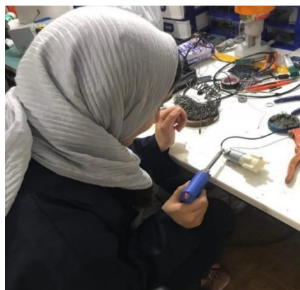
شکل ۷: لحیم کردن سیم ها به پمپ های R۳۸۵
