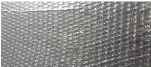
شکل ۵: پلی اتیلن سبک حبابدار که درون حباب ها محلول نانوذرات کیتوسان قرار گرفته
