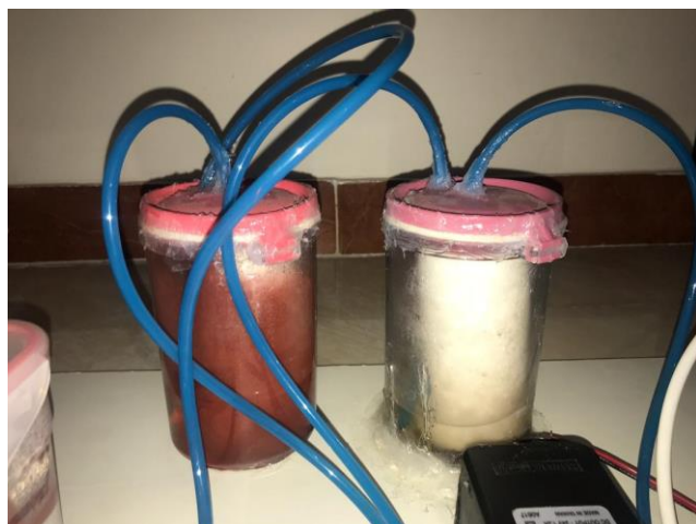
شکل ۱۰: فیلترهای ۵ و ۰/۲ میکرونی
