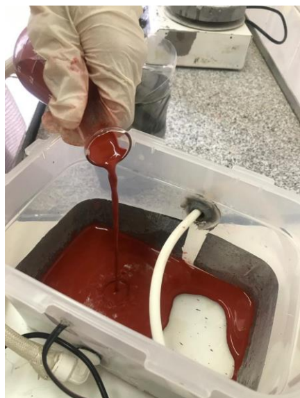
شکل ۱۴: ریختن محلول در فیلتر الکتروفتون
