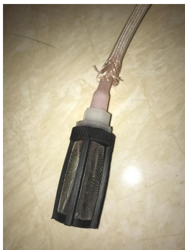
شکل ۱۱: فیلتر جاذب ذرات بزرگ و کربن اکتیو
