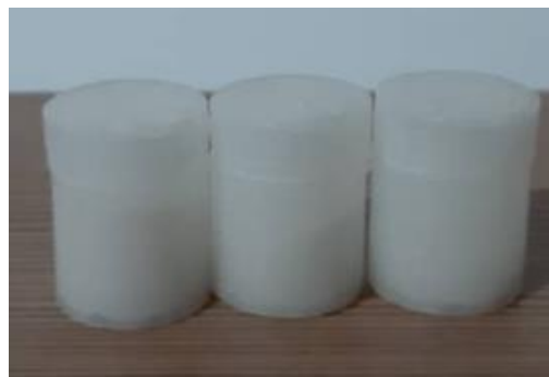
عکس ۲۵: فیلتر ها حاوی نانوذره ی کیتوسان
