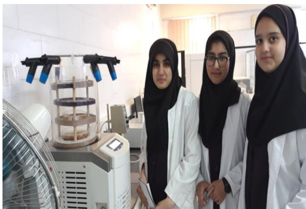
شکل ۳- استفاده دستگاه فریزدرایر برای خشک کردن نمونه‌ها
