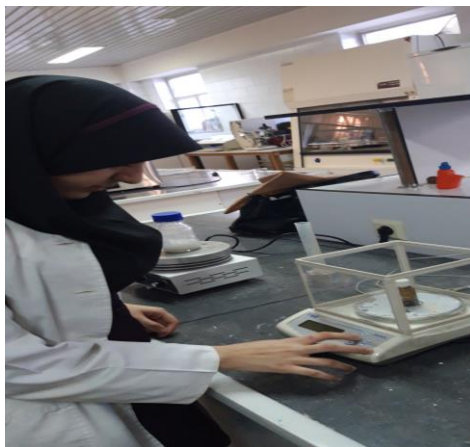
شکل ۲- در حال وزن گیری ، سمت چپ مشاهده مخلوط نانوالیاف سلولز و ژلاتین بر روی همزن مغناطیسی
