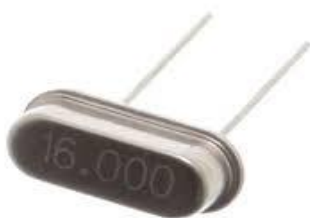
شکل ۲۳- نمونه‌ای از یک کریستال با فرکانس ۱۶ مگاهرتز
